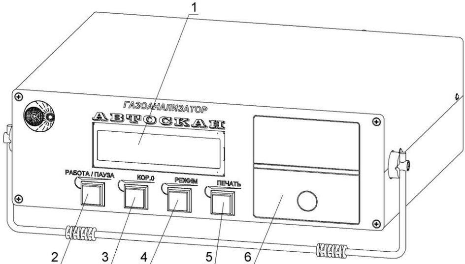
1-Дисплей; 2-Кнопка РАБОТА/ПАУЗА; 3-Кнопка КОР.0; 4-Кнопка РЕЖИМ; 5-Кнопка ПЕЧАТЬ; 6-Принтер (для модификации АВТОСКАН-01.02П и АВТОСКАН-01.02ТП)
