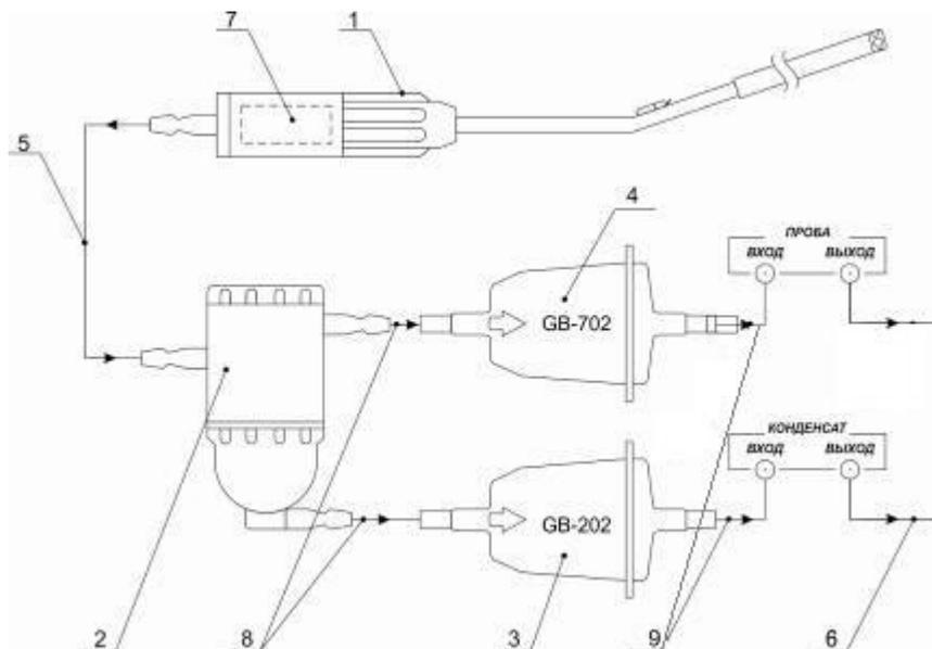
1-Пробозаборник; 2-Фильтр (каплеуловитель); 3-Фильтр очистки конденсата GB-202; 4-Фильтр тонкой очистки пробы GB-702; 5-Пробозаборная трубка; 6-Трубка 210 мм; 7-Фильтр грубой очистки; 8-Трубка 30 мм; 9-Трубка 150 мм.
