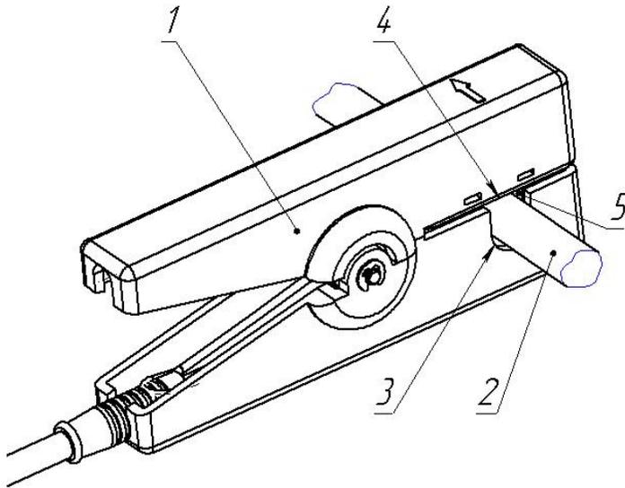
1-Зажим датчика тахометра; 2-Высоковольтный провод зажигания; 3- Паз; 4- Закрывающая пластина; 5- Сердечник
