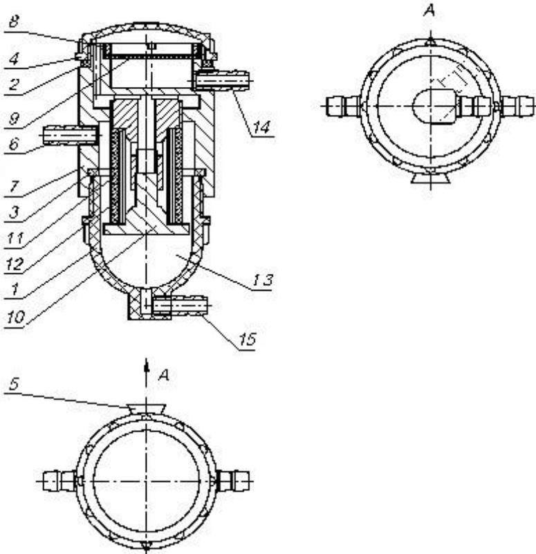
1-Колпачок; 2-Прокладка; 3-Прокладка; 4-Верхняя крышка; 5-Фиксатор; 6-Штуцер ВХОД пробы; 7- Корпус; 8-Гайка; 9- Фильтр тонкой очистки (диск); 10-Фиксатор; 11-Фильтр 5 мкм;12-Объемный фильтр; 13-Отсек для сбора конденсата; 14-Штуцер ВЫХОД пробы; 15-Штуцер ВЫХОД конденсата
