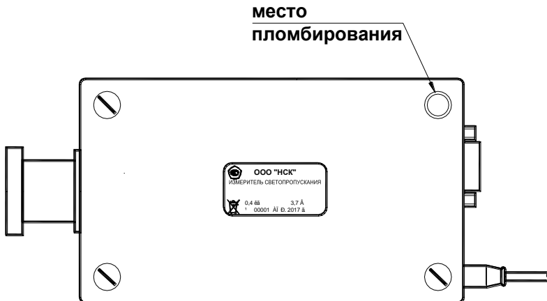
Рисунок 4 - Место пломбирования прибора от несанкционированного доступа
